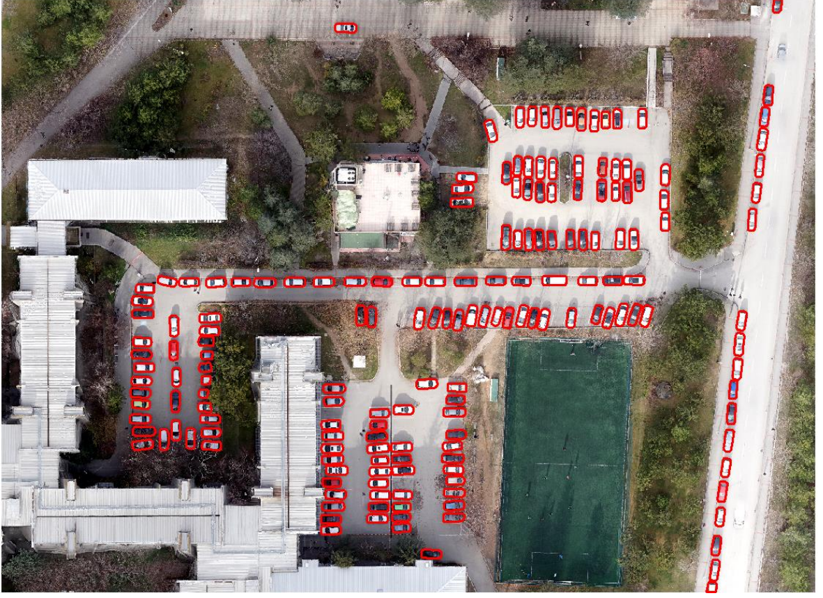
Şekil 3.25. Test Alanı #2'ye ait ortofoto üzerinden çizilmiş referans veriler (Kırmızı)
