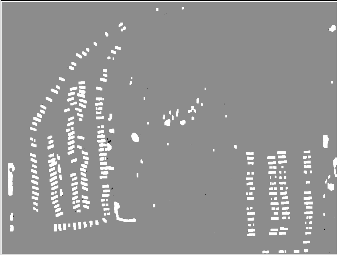
Şekil 3.23. Morfolojik filtre uygulanması sonrası Test Alanı #3' e ait nSYM
