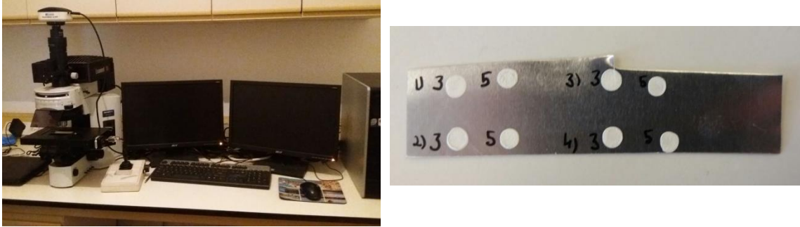
Şekil 3.1. Raman cihazı (solda) ve İTK (ince tabaka kromatografi) plaka üzerinde SERS örnekleri (sağda)
