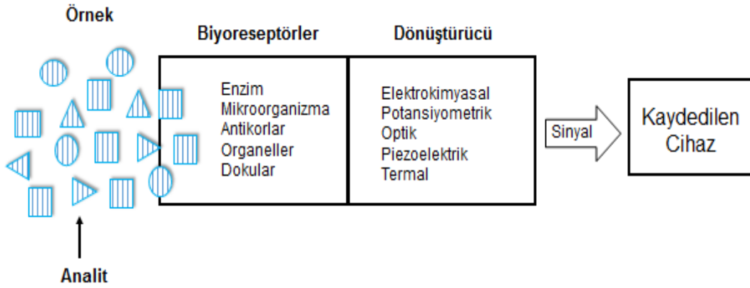
Şekil 2.5. Biyosensörlerin genel çalışma mekanizması
