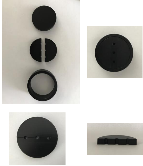
Şekil 3.2. Sıkışma dayanıklılık testi için örneklerin hazırlandığı teflon kalıbın görüntüleri.
