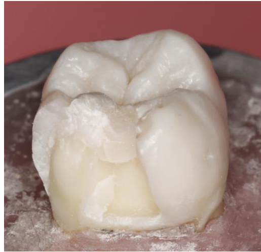
C: 'Adeziv + restorasyonda koheziv + diş dokusunda koheziv' kırılma tipine örnek (Tamir edilemez)
