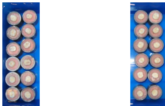
Şekil 3.22. Kırılma dayanıklılık testi için restore edilen ve distile suda bekletilen örnekler.
