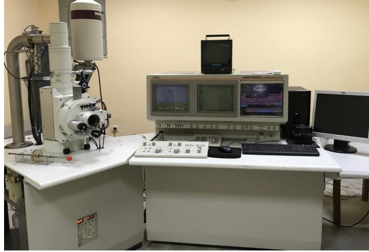
Şekil 3.25. Çalışmada kullanılan tarama elektron mikroskobu (JSM-6400 Scanning Electron Microscope, Jeol Ltd, Tokyo, Japan).
