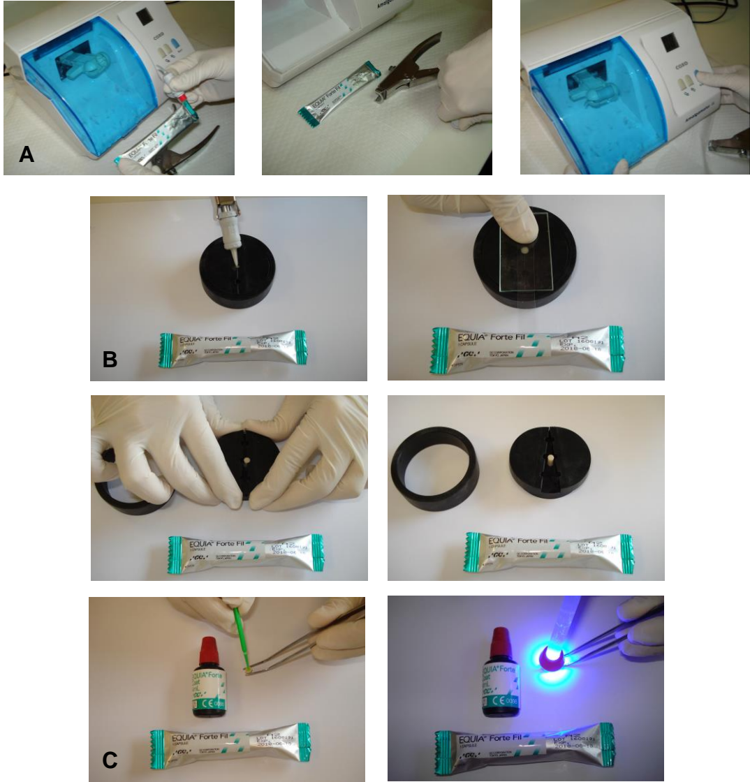
Şekil 3.4. A: Cam hibrit kapsülünün karıştırılması; B: Cam hibrit örneklerin hazırlanması; C:Yüzey örtücü uygulaması.
