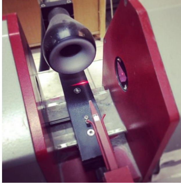
Şekil 7.1 Lazer kırınımı ile tane boyu dağılımı belirleme cihazı
