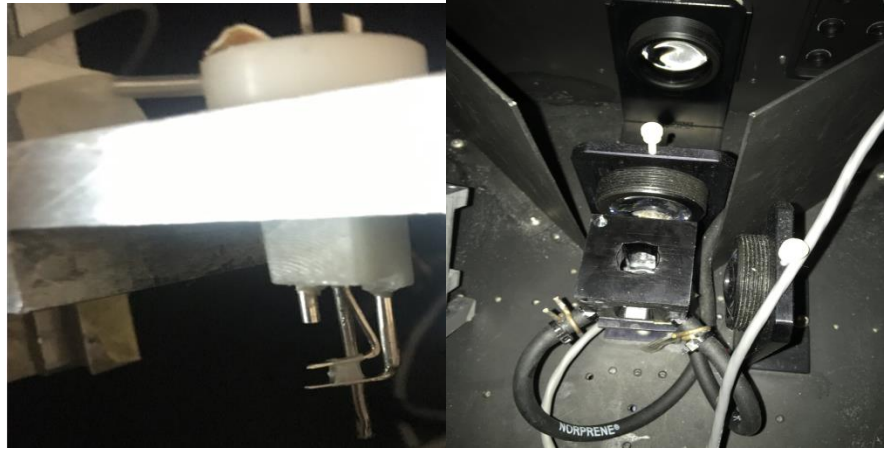
Şekil 3.1. Hücre içi Ca^{+2} konsantrasyonundaki değişikliklerin izlendiği deneylerde ana PA halkasının sisteme yerleştirilmesi
