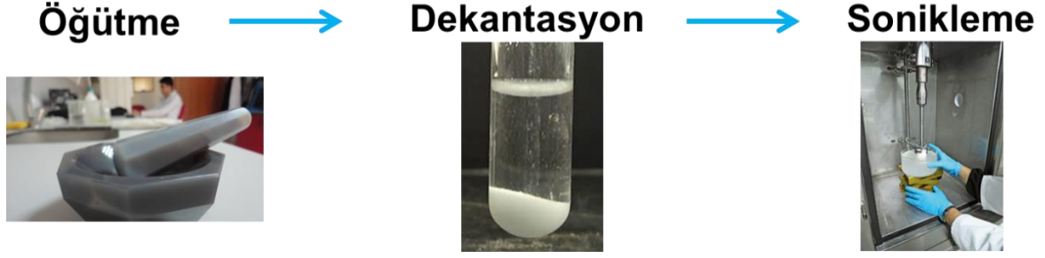
Şekil 3.4. Ticari olarak edinilen Ibuprofen kristallerinin küçük ve eşboyutlu hale getirilmeleri için, mikrokapsül çalışmaları öncesinde uygulanan işlem sırası
