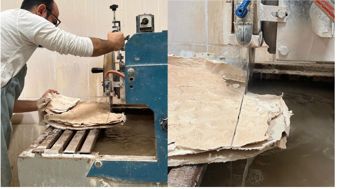
Görsel 46. Kesim sürecinde sulu kesim makinesi ile iç katmanların görünür hale getirilmesi.
