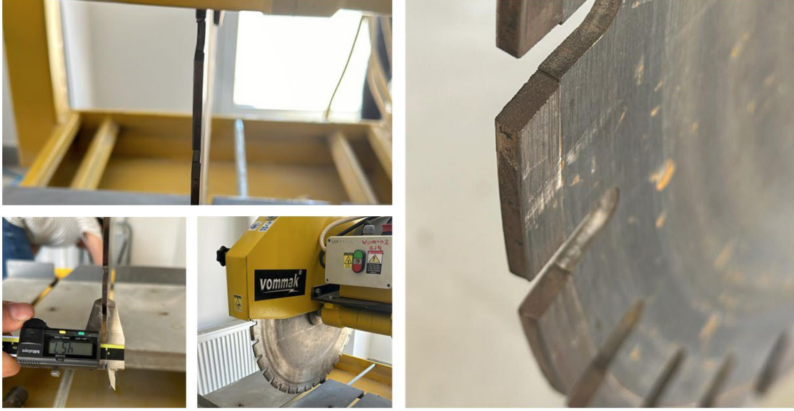
Görsel 43. Sulu kesim makinesi ve detayları.
