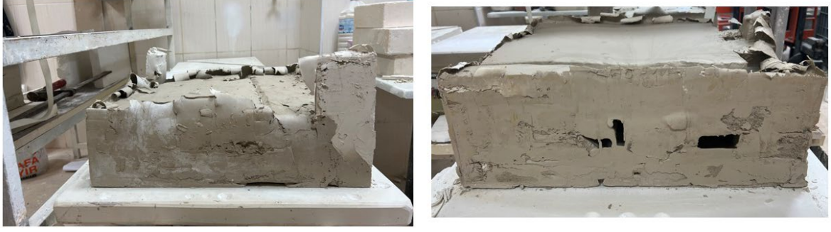
Görsel 39. Kalıp açıldıktan sonraki yüzey detayları.
