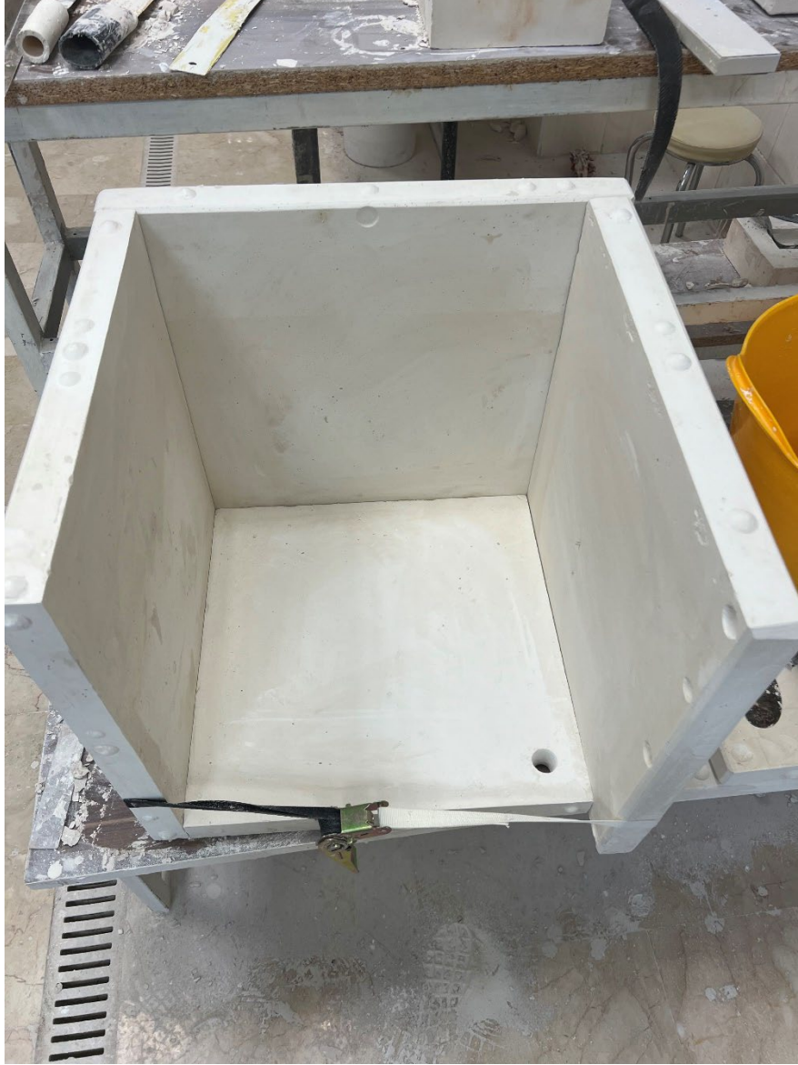
Görsel 29. Döküm öncesi kalıp montajı.
