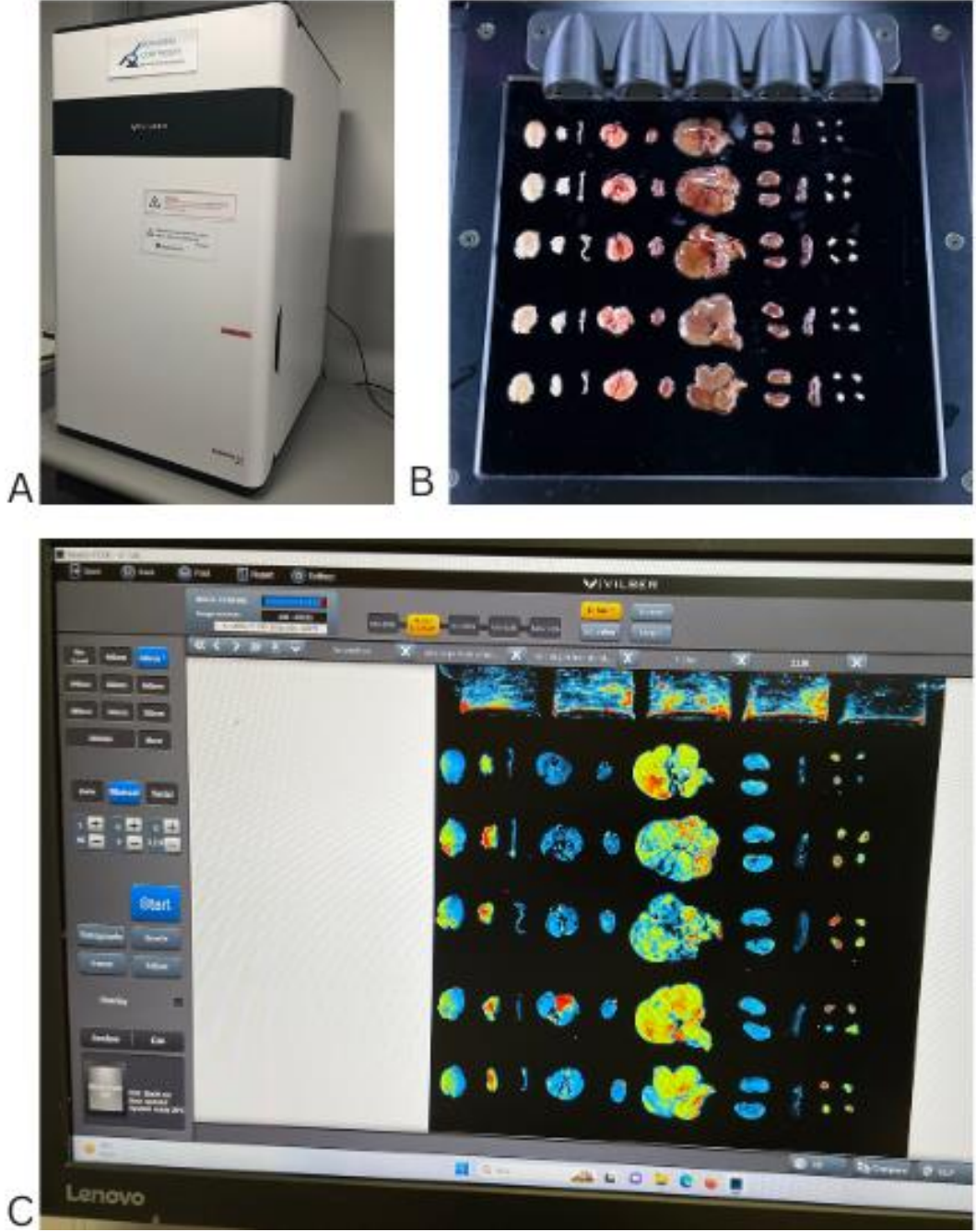
Şekil 4-16. Biyodağılım çalışmasında ex vivo görüntüleme. A. Newton 7.0 hayvan görüntüleme cihazı B.Organların tablaya dizilmiş hali C.Yazılımda alınan görüntü
