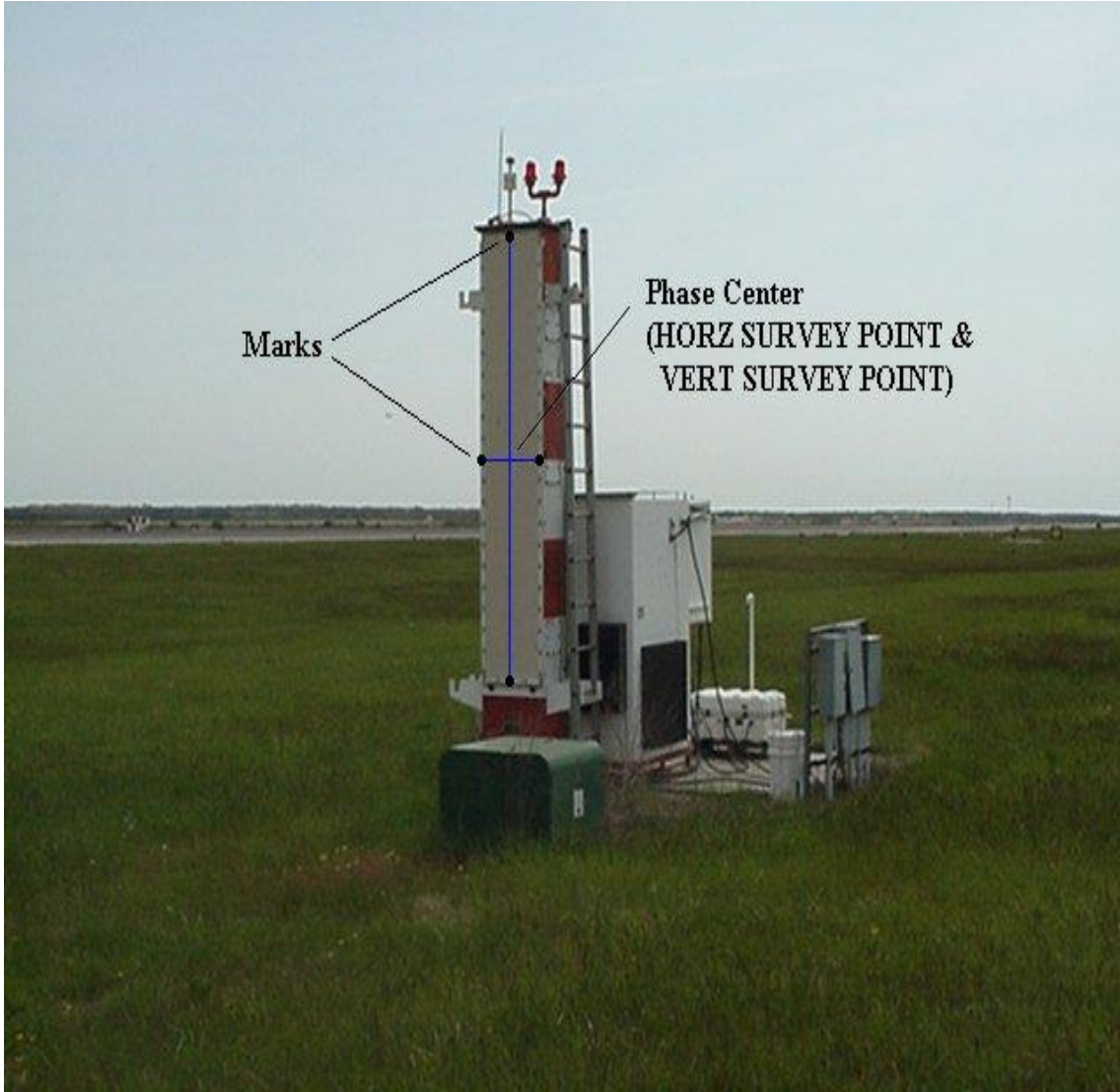
Şekil 3.3. MLS Yükseliş Tarama Anteni [28]
