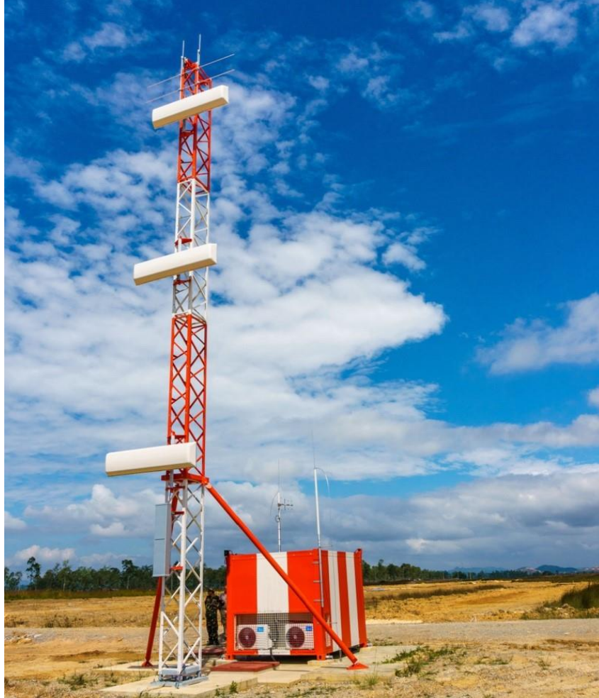
Şekil 2.8 ILS Glideslope Yer İstasyonu [10]
