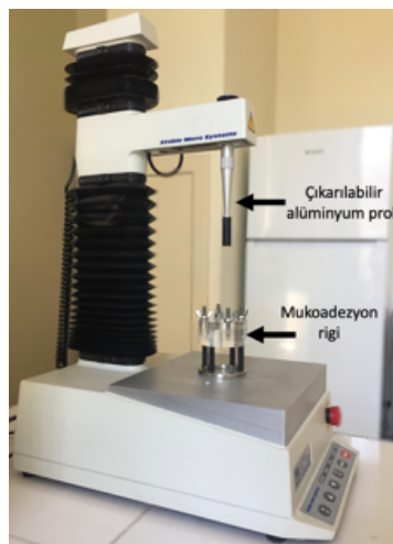
Şekil 3.1. TA-XT Plus model tekstür analiz cihazı.
