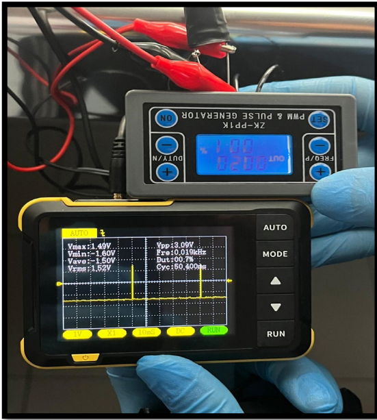
Şekil 3.14. Elektriksel stimülasyon uygulama anında ZK-PP1K (üstte) ve osiloskop (altta) görüntüsü
