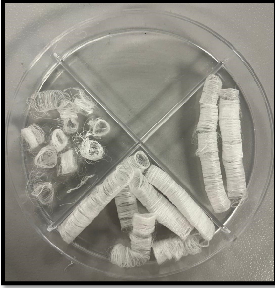
Şekil 3.7. Kullanıma hazır polikaprolakton fiberleri
