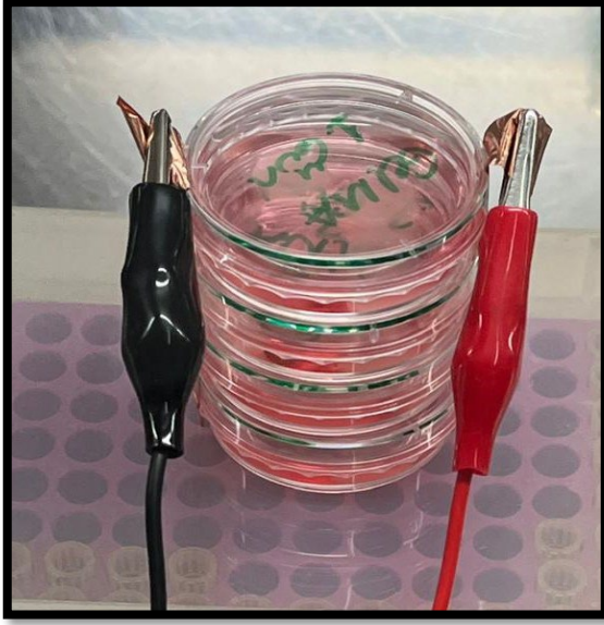
Şekil 3.13. Elektriksel stimülasyon uygulama anında petri kaplara yapıştırılan bakır bantlar ve onlara tutturulan timsah elektrotların görüntüsü
