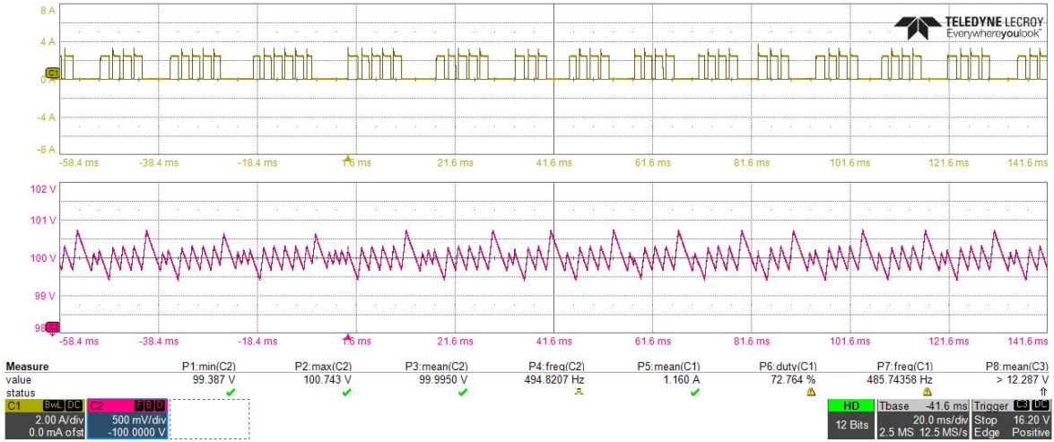
Şekil 8.24 Sabit akım modu (azami yük), 1.1A pil şarjı (CH1:Şarj Akımı, CH2:Ana Bara Gerilimi)
