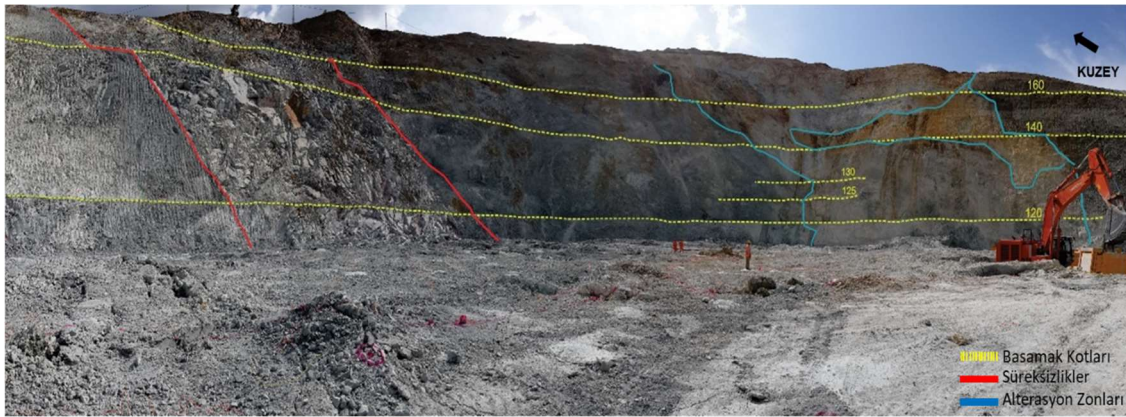
Şekil 1-5 Çoraklıktepe 120-180 kotları süreksizlikler ve alterasyonların görünümü (Kişisel arşiv 2013).
