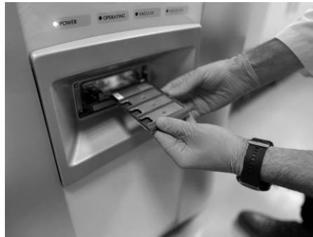
Şekil 2.9. MALDI TOF MS hedef slaydının cihaza yüklenmesi.
