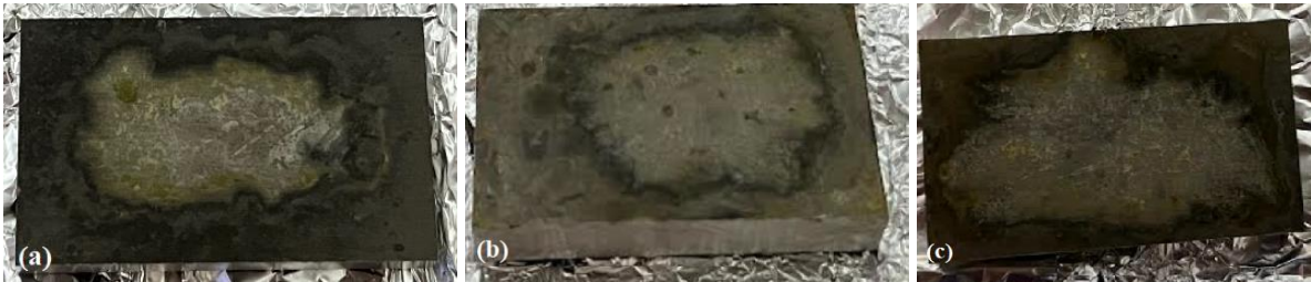
Şekil 3.22 (a) KK kaplanmış BTA@HNT ile kaplanan Al-7075 yüzeyinin nitrik asit ile muamelesi (b) KK kaplanmış BTA@Kalsine 1 HNT ile kaplanan Al-7075 yüzeyinin nitrik asit ile muamelesi (c) KK kaplanmış BTA@Kalsine 2 HNT ile kaplanan Al-7075 yüzeyinin nitrik asit ile muamelesi
