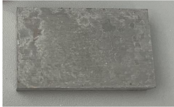
Şekil 3.21 Poli(maleik anhidrit-ard-akrilik asit) kopolimerinin korozif AL-7075 yüzeyinden uzaklaştırılması
