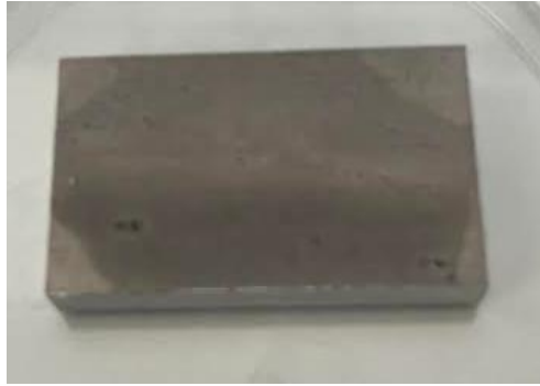
Şekil 3.17 Poli(MA- ard -AA) kopolimeri ile kaplanan Al-7075
