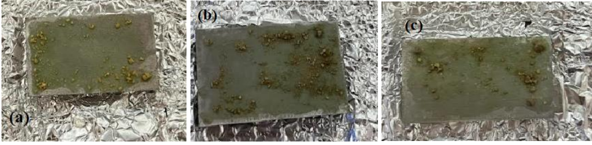
Şekil 3.18 (a) KK kaplanmış BTA@HNT ile kaplanan Korozif Al-7075 (b) KK kaplanmış BTA@Kalsine 1 HNT ile kaplanan Korozif Al-7075 (c) KK kaplanmış BTA@Kalsine 2 HNT ile kaplanan Korozif Al-7075
