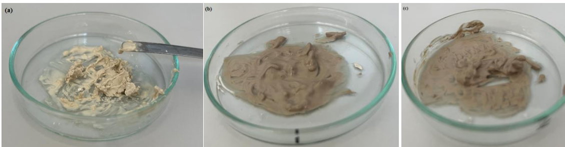
Şekil 3.11 (a) KK kaplanmış BTA@HNT (b) KK kaplanmış BTA@Kalsine 1 HNT (c) KK kaplanmış BTA@Kalsine 2 HNT
