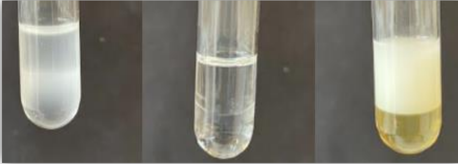
Şekil 3.3. Biyosümfektan varlığının E_{24} yöntemi ile belirlenmesi.
