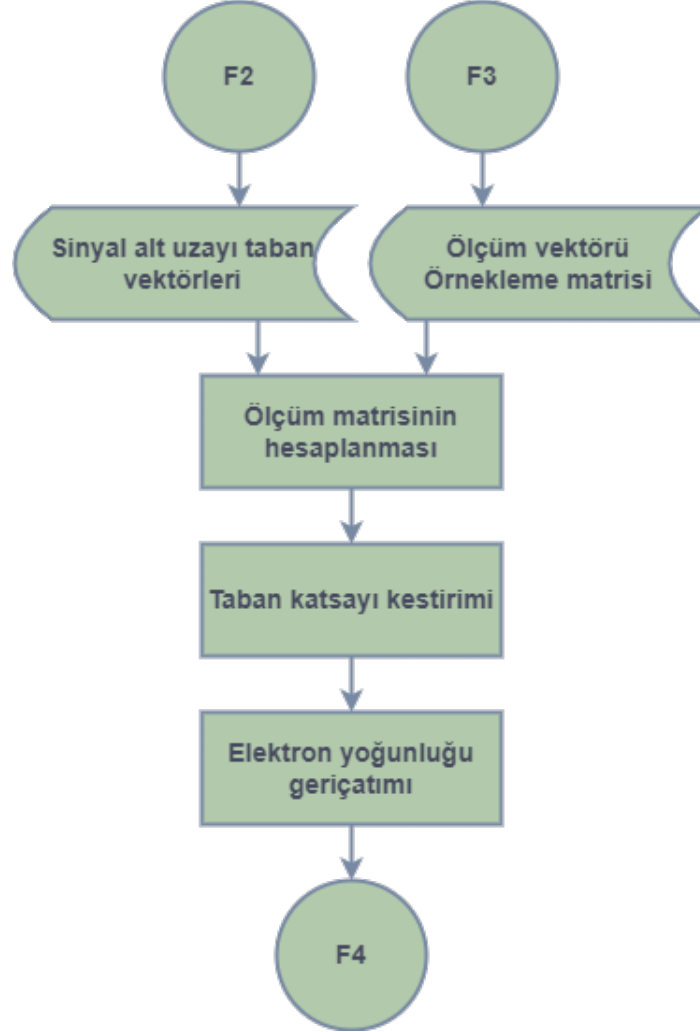
Şekil 4.7: Elektron yoğunluğu yeniden yapılandırma adımlarını gösteren akış şeması F4.
