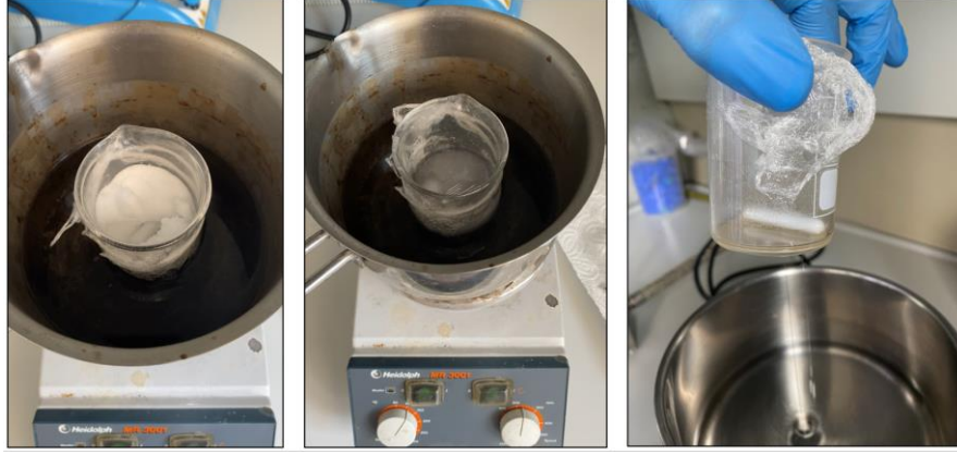
Şekil 4.3. 1:2 (mol/mol) Oranında Karıştırılan Kolin Klorür ve Üreden Derin Ötektik Çözücü Hazırlama Aşamaları
