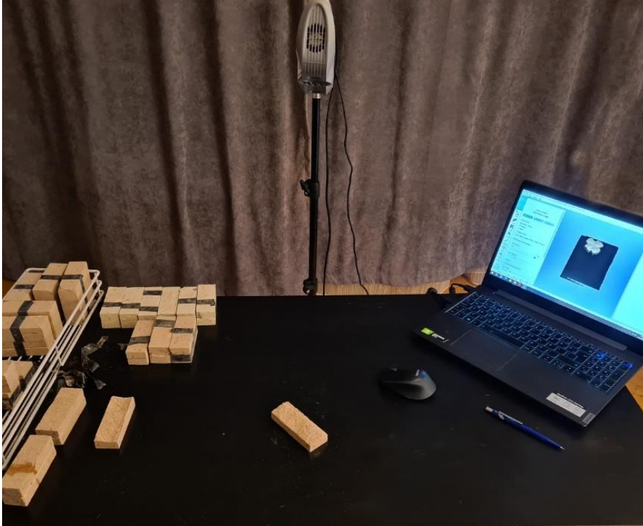
Şekil 6.9: İğnimbirit örneklerin optik tarayıcı ile taranmasına ilişkin görüntü.
