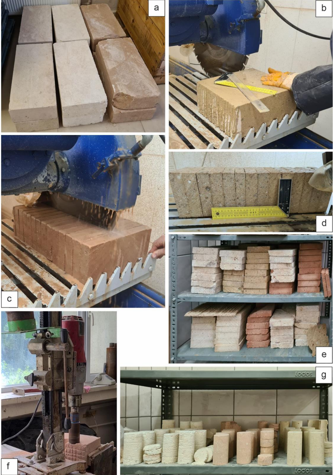
Şekil 5.36: İgnimbirit bloklarından dayanım ve makaslama deneylerinde kullanılmak üzere örnek hazırlama aşamaları.
