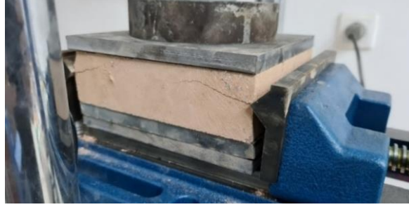
Şekil 5.41: 0.05 MPa'lık normal gerilme altında mengene düzeneği yardımıyla süreksizlik yüzeyi oluşturma işleminde meydana gelen kırıklar.
