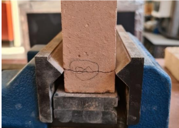
Şekil 5.43: Normal gerilme uygulanmadan, prizmatik kare örneğin döndürülerek konumlandırılması sonucu mengene düzeneği yardımıyla oluşturulan süreksizlik yüzeyi.
