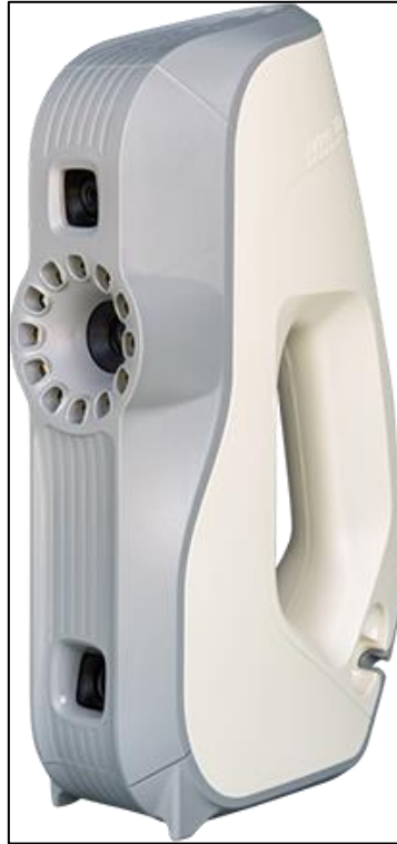
Şekil 6.4: Örneklerin sayısallaştırılmasında kullanılan Artec Eva isimli üç boyutlu optik tarayıcı ( www.artec3d.com ).
