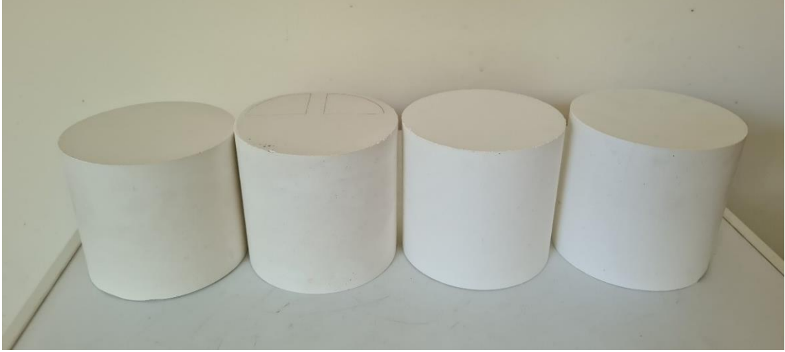
Şekil 5.2: Schmidt çekici ile tek eksenli sıkışma dayanımının belirlenmesinde kullanılan büyük karot örnekleri.
