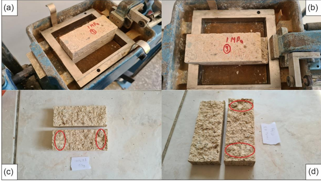
Şekil 8.2: Sarı renkli bir ıgnımbırit örneğinin makaslama düzeneği içerisindeki (a) deney öncesi, (b) deney sonrası görüntüleri ile (c) - (d) deney sonrasında oluşan deformasyonlara ilişkin görüntüler.
