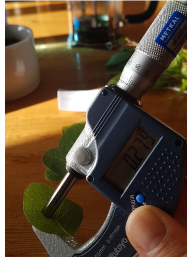
Şekil 3.11 Araziden toplanan yaprak örneklerinin aynı gün içinde (a) taze ağırlıklarının, (b) alanlarının, (c) kıvrıklarının ve (d) kalınlıklarının ölçülmesi.
