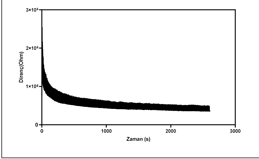
Şekil 4.27. %25 GNP-TPU içeren sensörün (2) ön koşullandırma testi
