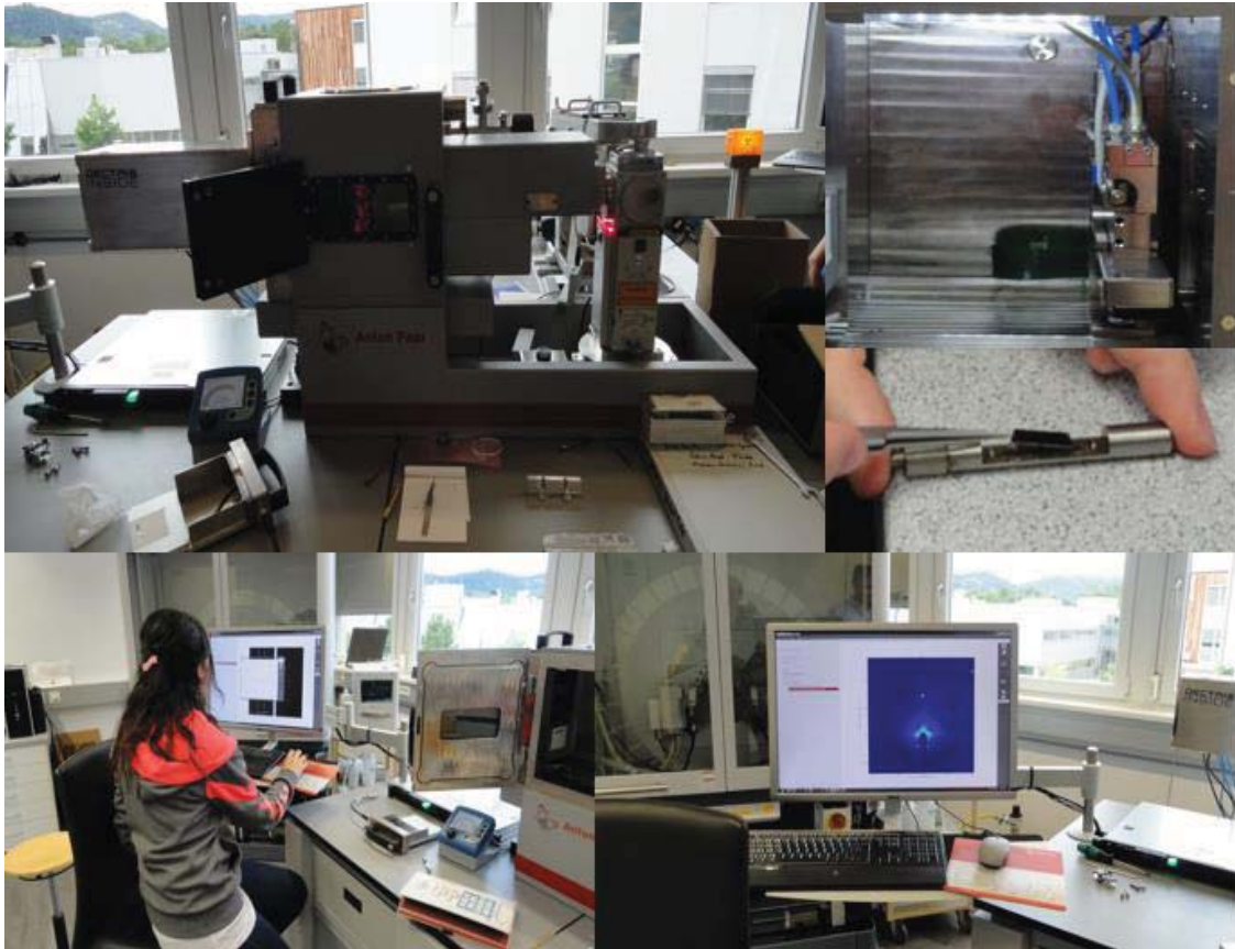
Şekil-4.1. Anton Paar GISAXS deney sistemi ve örneklerin ölçüm aşamaları ile ilgili görseller.
