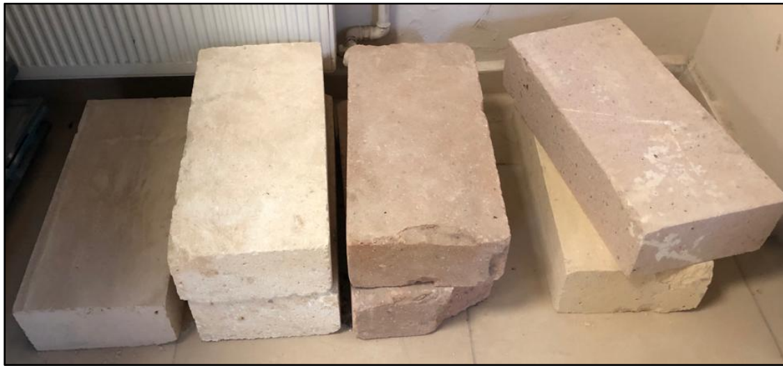
Şekil 3. 4. Deneylerde kullanılmak üzere alınan İgnimbirit bloklarının bir kısmından görünüm.
