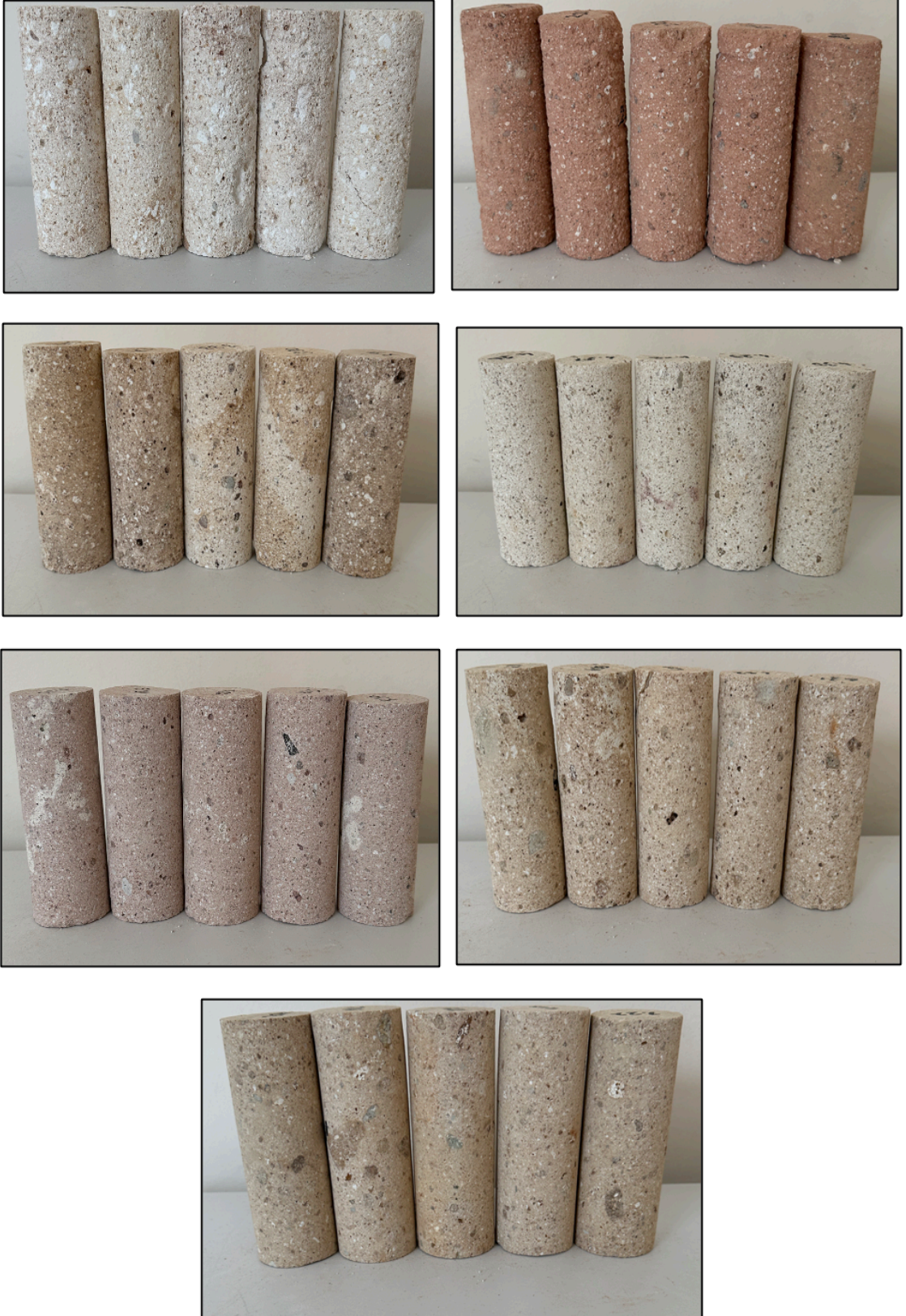
Şekil 4. 1. 7 farklı ignimbirit örneğinden alınan NQ çaplı (47.6 mm) karotların bir kısmından görünüm.
