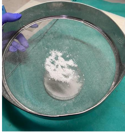
Şekil 3.1. Toz haldeki katkı malzemelerinin partikül boyut analizi
