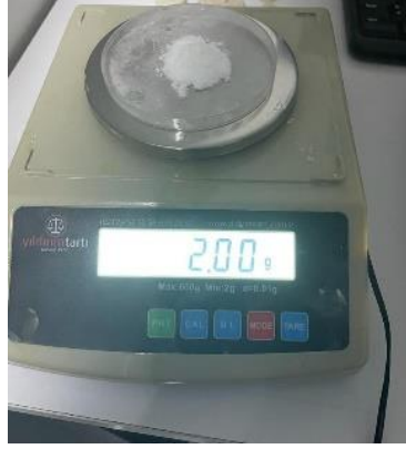
Şekil 3.2. Toz haldeki katkı malzemelerinin hassas terazide tartılması
