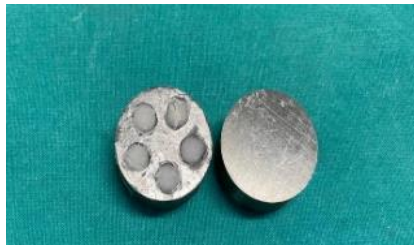
Şekil 3.4. Basma testi numune kalıbına dökülmüş kemik çimentosu ve baskı plakası
