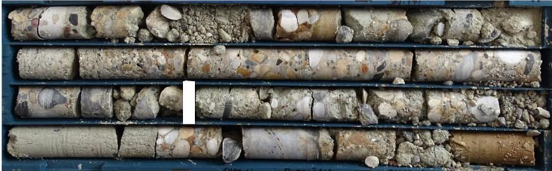
Şekil 3.10. Tez kapsamında incelenen AB-33 nolu sondajda Yatağan Formasyonu'nun taban seviyesinde görülen ve tez kapsamında Sekköy Formasyonu'ndan ayrılmasında kılavuz olarak kullanılan konglomeraların görünümü.
