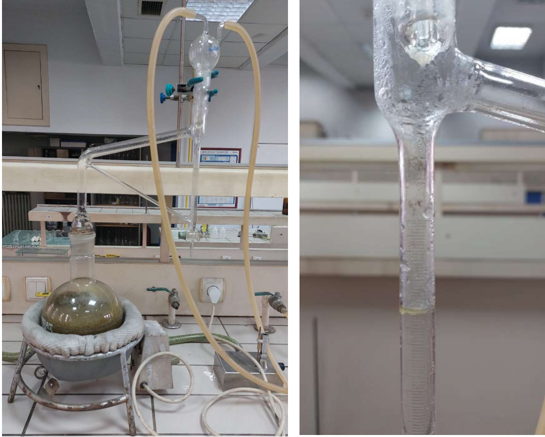
Şekil 4.73. Clevenger düzeneği ve toplanan uçucu yağın görüntüsü
