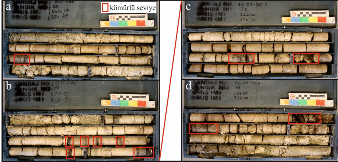
Şekil 3.29. SG-3 nolu sondaj kuyusundan alınan karotlardaki organik seviyeler, a) 72 nolu sandık (308.00-313.40m), b) 74 nolu sandık (318,30-322,50m), c) 75 nolu sandık (322.50-326.30m), d) 76 nolu sandık (326.30-332.00m)
