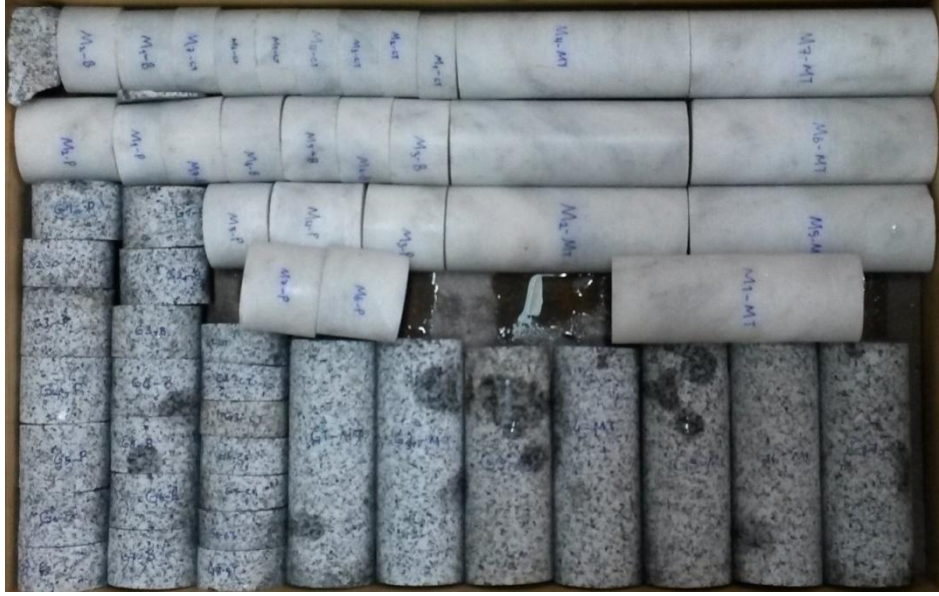
Şekil 3.3. Kaya mekaniği deneyleri için hazırlanan granit ve mermer karotlarından bir görüntü.
