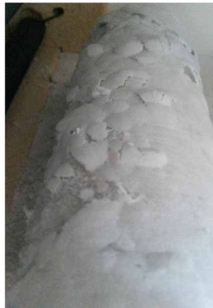
Şekil 4.12.(a) 800° C'de ısıtılınca dağılan M6 no.lu örnek, (b) 700°C'de ısıtılınca dağılan M7 no.lu örnek (şeker yapısı).
