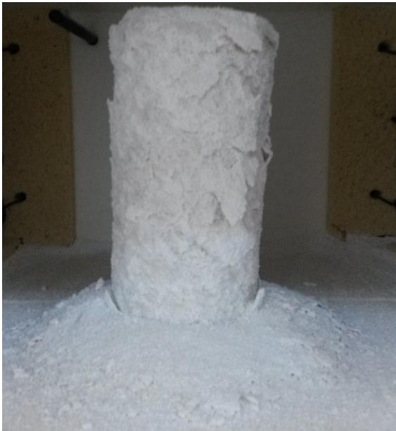
Şekil 4.12.(a) 800° C'de ısıtılınca dağılan M6 no.lu örnek, (b) 700°C'de ısıtılınca dağılan M7 no.lu örnek (şeker yapısı).
