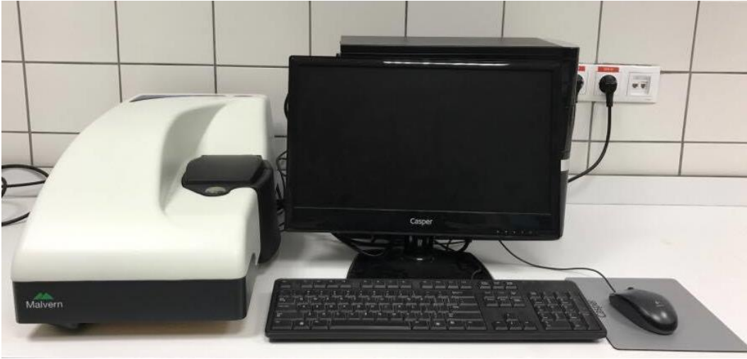
Şekil 3.5. SDS miselleri ve SDS-L-Lys-Cu 2+ misel komplekslerinin ortalama partikül boyutunun ölçümünde kullanılan zeta boyut ve potansiyel analizörü.
