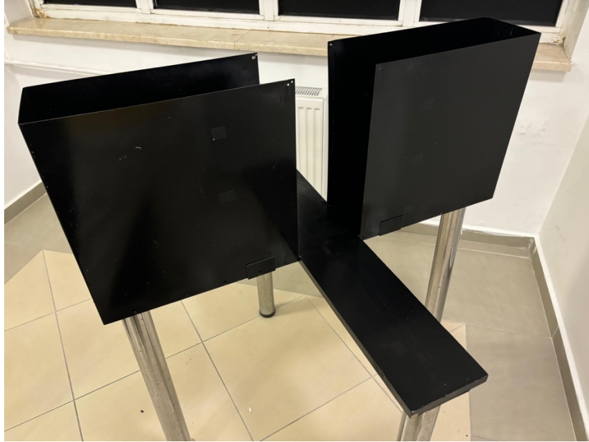
řekil 3.3. Yükseltiľmiř artı testi platformu. Sıanlar merkeze yzleri aık kola bakacak řekilde yerleřtirildi ve aık kolu keřfetme sreleri 5 dakika boyunca kaydedildi.
