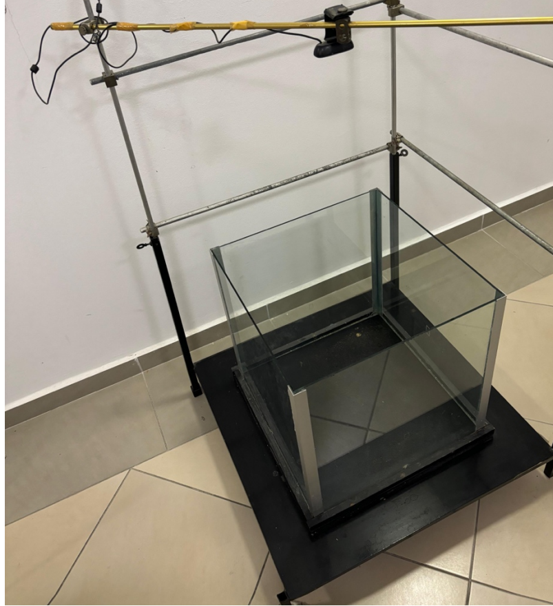
Şekil 3.5. Açık alan arena testi. Sıçanlar arenanın tam ortasına bırakıldı. Sıçanların merkez alanda geçirdikleri süre ve merkez alana geçiş sayıları anksiyete benzeri davranışı ölçmek için kullanıldı.
