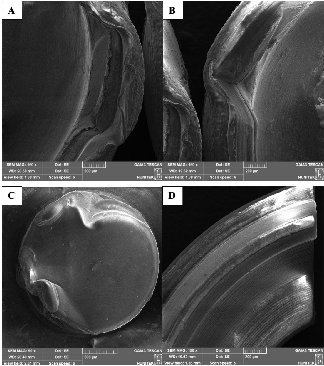
Şekil 4.11. Ataçmanların deney sonu deforme yüzeylerinin yakın görüntüsü: A) Mavi naylon ataçmanın iç kenarındaki deforme alan B) Pembe naylon ataçmanın iç kenarındaki deforme alan C) Şeffaf naylon ataçmanın iç çıkıntısındaki deforme alan D) Beyaz PEEK ataçmanın çentik kısmında görülen deforma alan E) Sarı PEEK ataçmanın dış kenarında görülen deforma alan F) Sarı PEEK ataçmanın çentik kısmında görülen deforma alan G) Yeşil PEEK ataçmanın dış kenarında görülen deforma alan H) Yeşil PEEK ataçmanın çentik kısmında görülen deforma alan.
