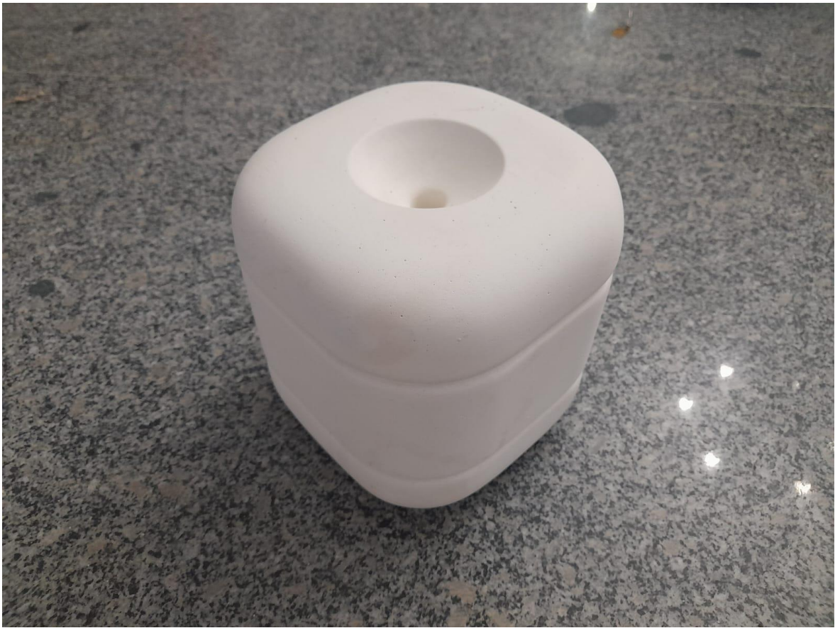
Görsel 39. Kemal Savcı Fidan 2023, A Boş Alçı Döküm Kalıbı (Kemal Savcı Fidan, kişisel fotoğraf arşivi)
