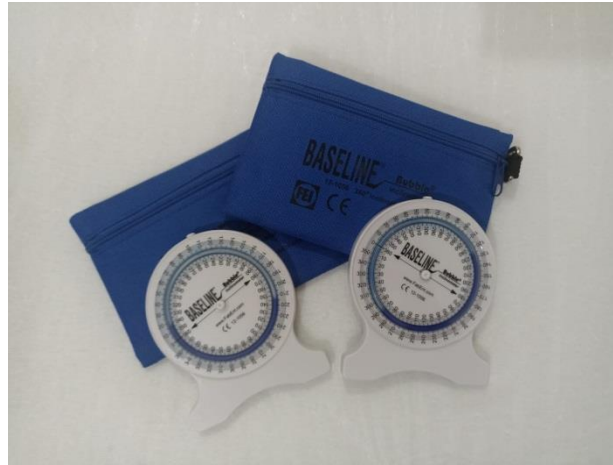
Şekil 3.3. Baseline bubble inklinometre.
