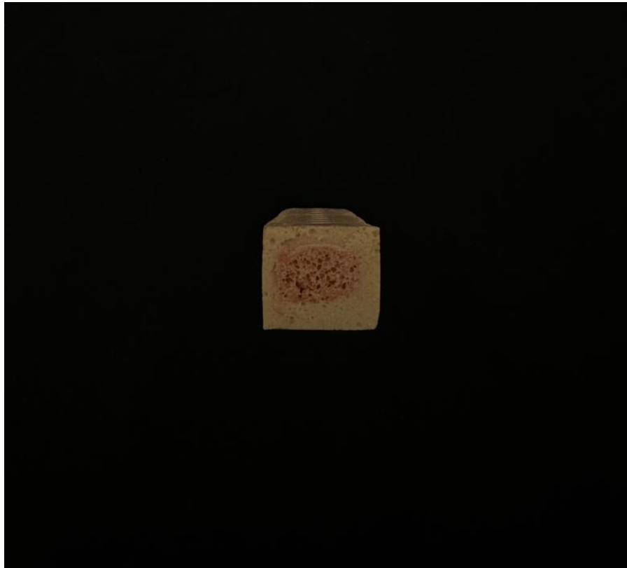
Resim 3.2. İçi süngerimsi, dış yüzeyleri kortikal olan yapay kemik modeli
