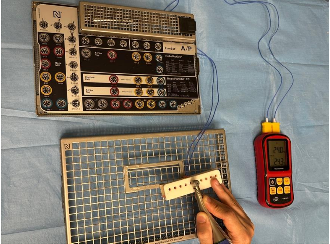
Resim 3.9. İmplant yuvalarının açılması sırasında termometreye bağlı K tipi termokupl uçları ile 2 farklı noktadan sıcaklık ölçümü
