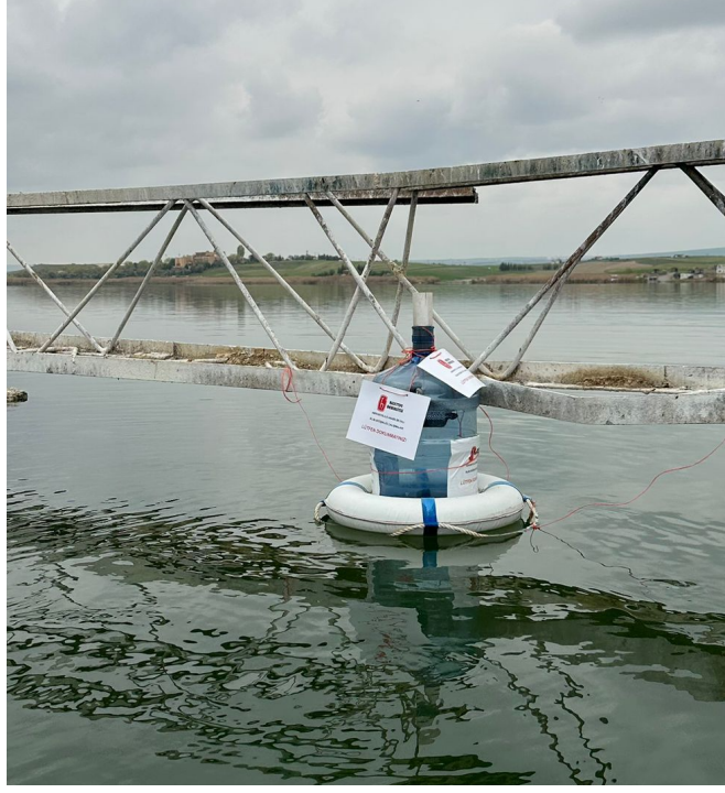
Şekil 3.1. CO 2 ölçüm düzeneği, İstasyon 4 açığı
