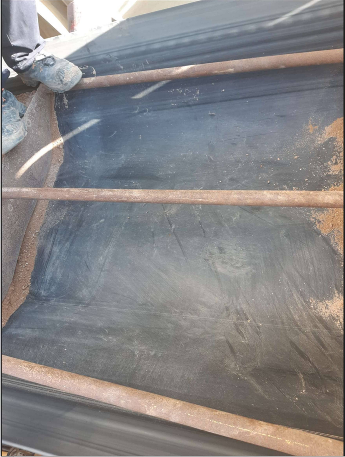
Şekil 29. Numune alma aparatı kullanımı ile numunenin alınması Numune arasındaki tüm cevher alınarak belirlenmiş numune taşıma kabına konulur.
