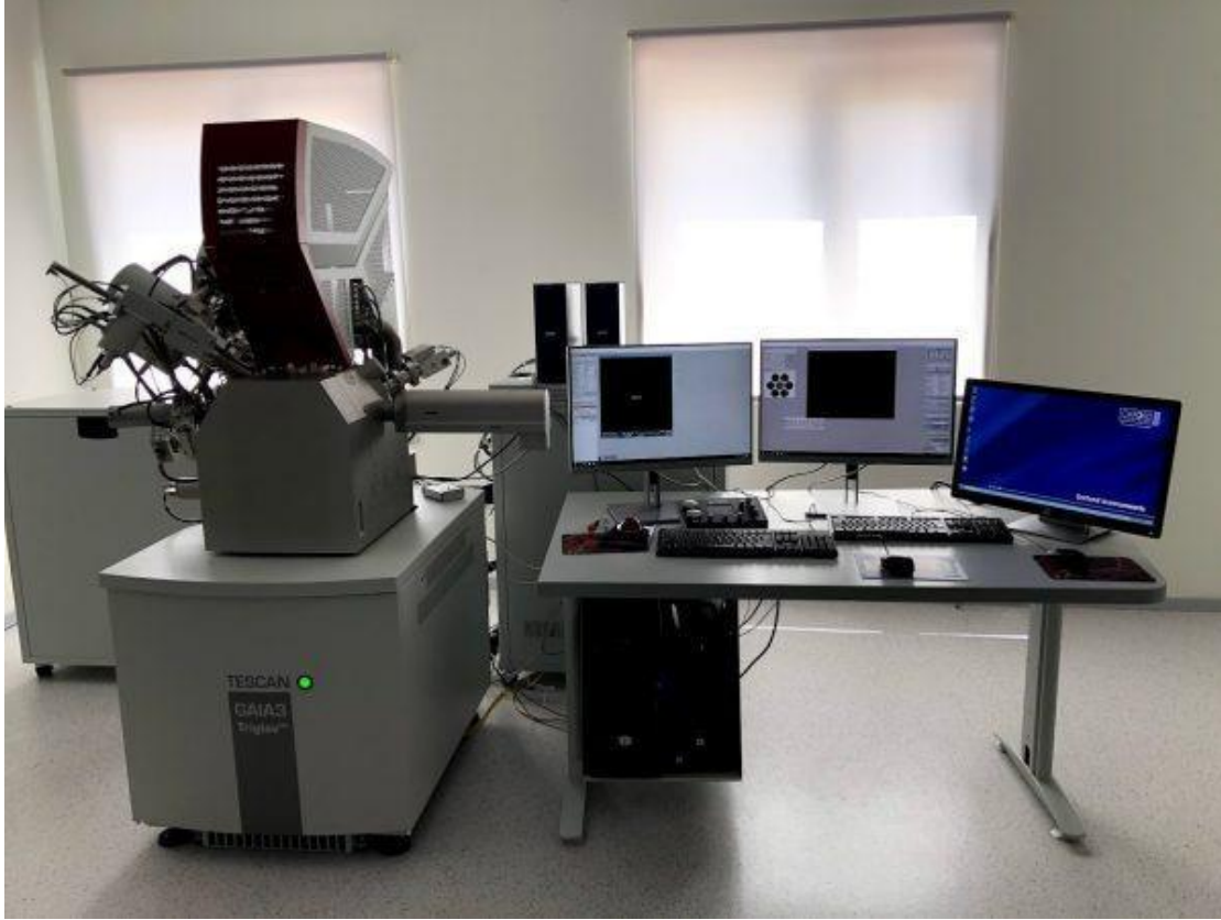
Şekil 3.12. TESCAN marka GAIA3 +Oxford XMax 150 EDS model SEM Cihazı [68]
