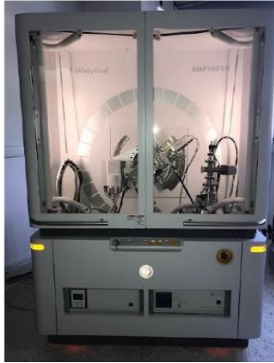
Şekil 3. 10. Panalytical Empyran Marka X-ışını Kırınımometresi [66]
