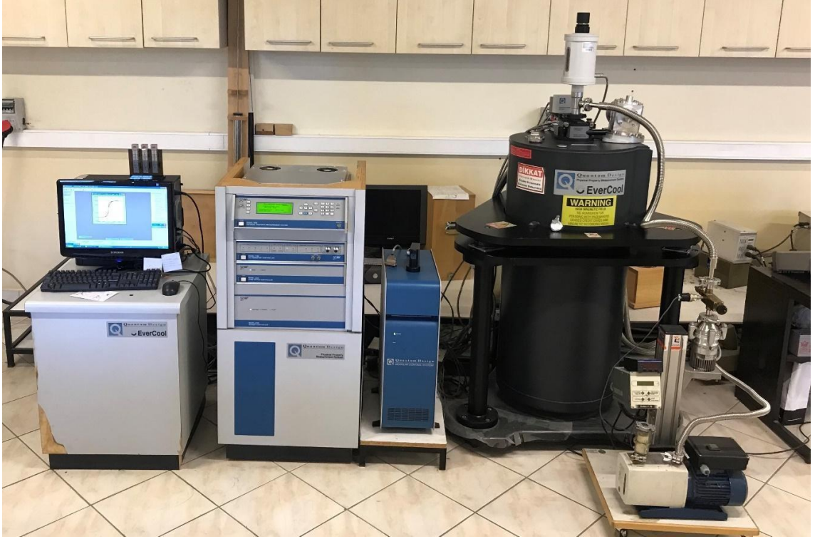
Şekil 3.17. Fiziksel Özellikler Ölçüm Düzeneği (PPMS)
