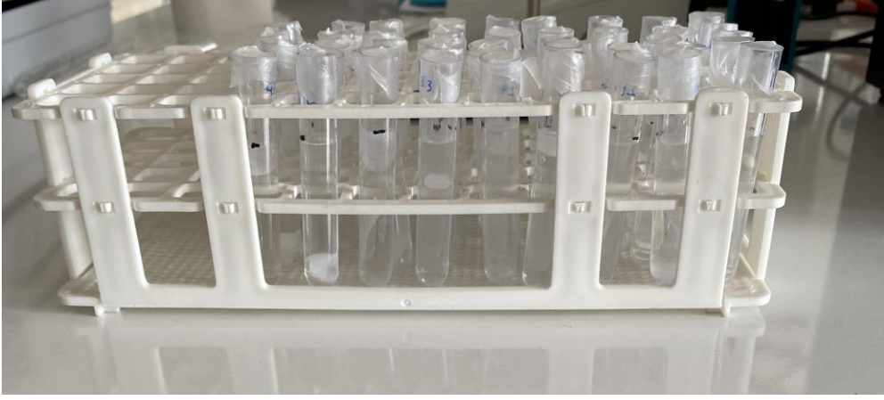
Şekil 3.2. Şişme ve degradasyon çalışmaları için hazırlanan tüpler
