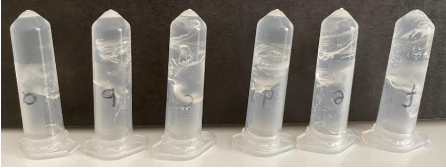
Şekil 3.1. Faz ayrımı testi için ependorf tüplerde hazırlanan jeller
