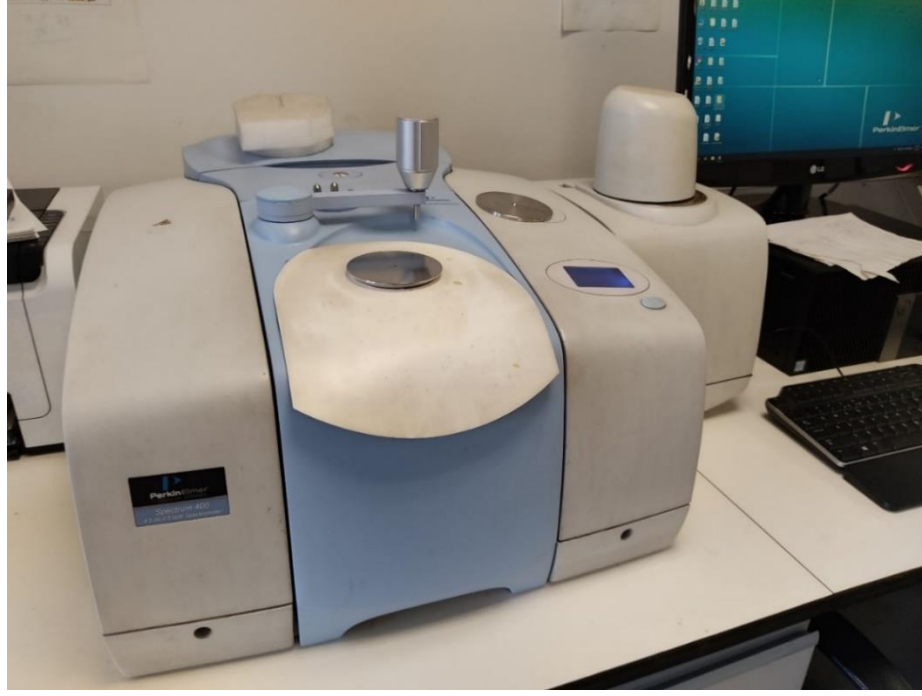
Şekil 3.8: Çalışmada kullanılan Perkin Elmer üretimi ATR-FTIR cihazı
