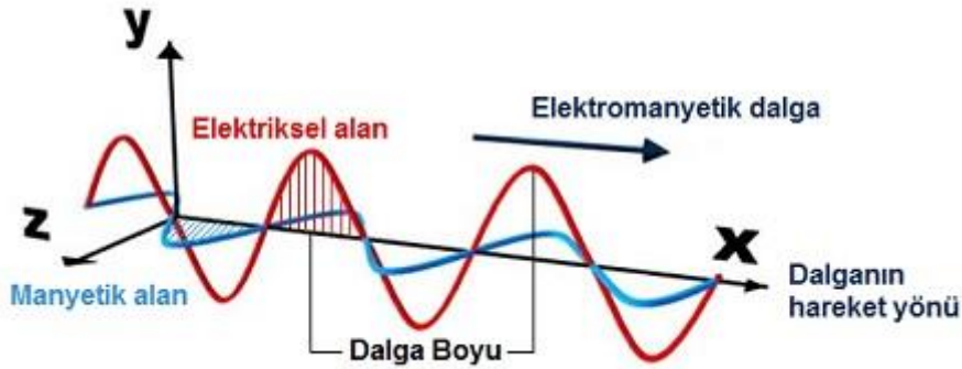
řekil 2.4: Elektromanyetik dalga rneęi (Kırmızı dalga: Elektriksel dalgayı gsterirken, mavi dalga ise manyetik alanı temsil etmektedir) [27].
