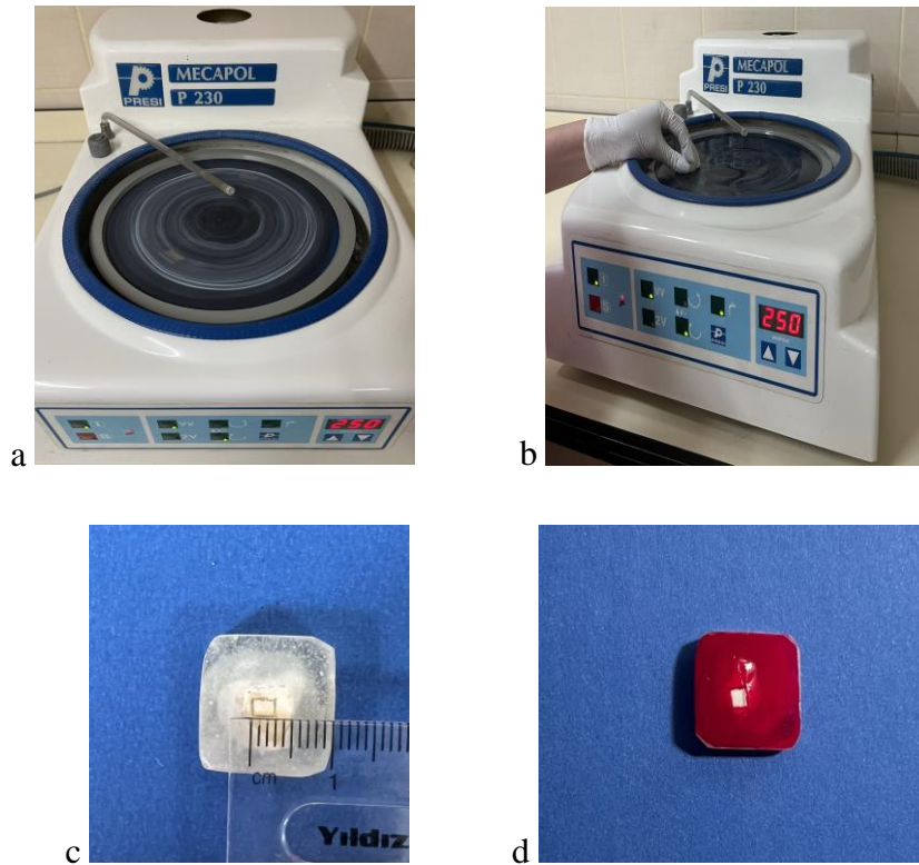
Şekil 3.2. a Polisaj cihazı (Presi Mecapol P230, 38320 Brié et Angonnes, Grenoble, Fransa) b. Mine yüzeylerine 250 rpm hıza sahip polisaj uygulaması c. Akrile gömülü mine yüzeyinde 3x3 mm'lik alan işaretlenmesi d. Oje ile kaplanmış örnek
