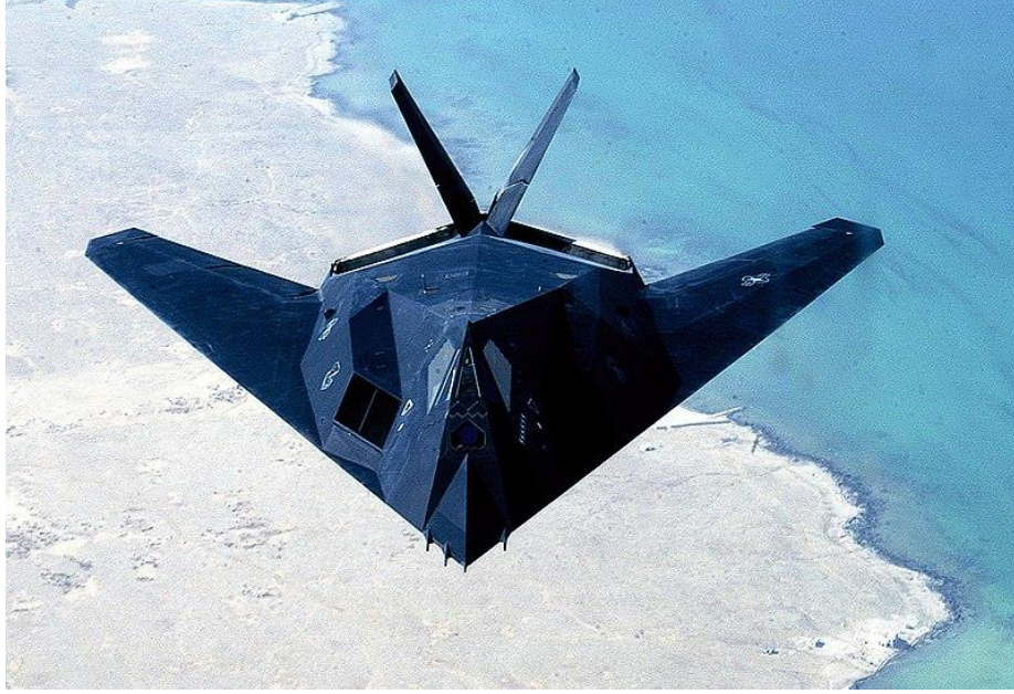
Şekil 2.4 RADAR kesit alanı azaltılmış ilk savaş uçağı F-117 Nighthawk [43]
