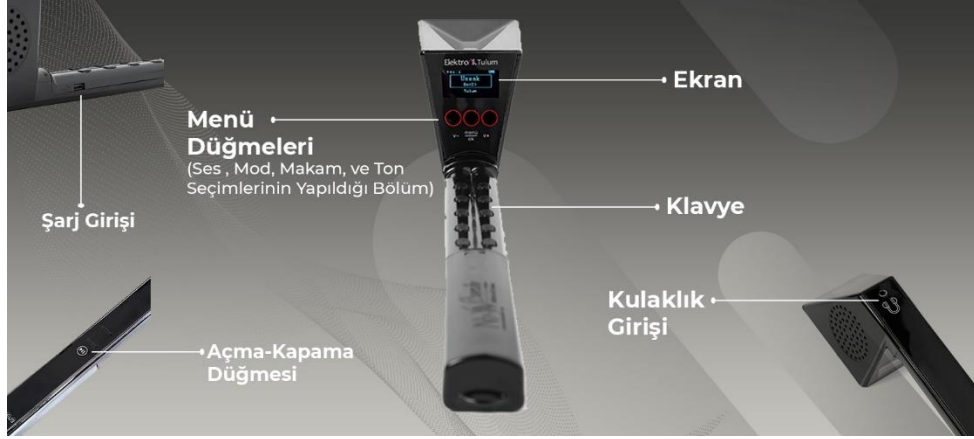
Görsel 78. Tulum çalgısının elektronik versiyonu navtronikin yapısı (URL-70).
