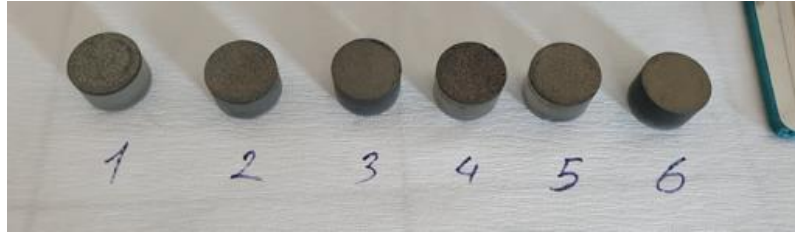
Şekil 13. Epoksinin sertleşmesi ile kaplardan çıkarılan kesitler
