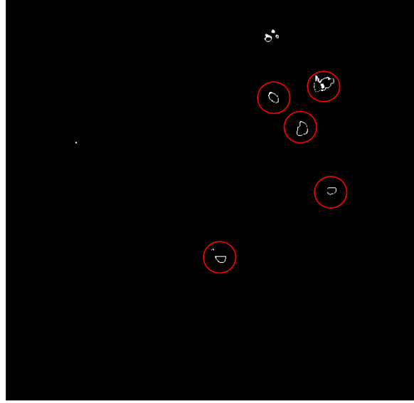
Şekil 47. Bor cevheri 80 – 134 fazındaki bir kesitteki x-ışını sertleşmesi etkisi
