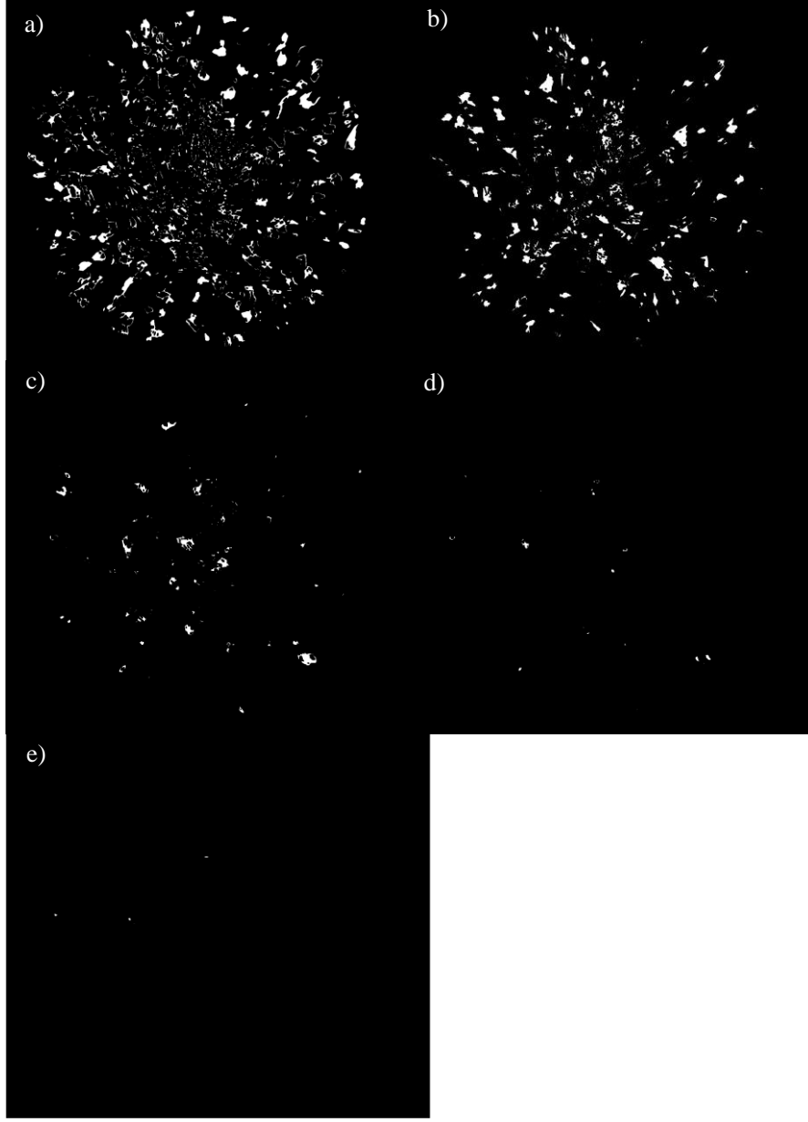
Şekil 35. Kurşun-çinko cevheri \mu CT görüntüsünden kapama ve aşındırma eklentileri kullanıldıktan sonraki fazlardan örnek kesitler a) 26-33 b) 33-45 c) 45-85 d) 85-137 e) 137-255 Elde edilen her bir fazda 1000 ‘den fazla görüntü bulunmaktadır. Fazlardaki tane sayısının, yüzey alanının ve hacim verilerinin belirlenebilmesi için ImageJ içinde bulunan 3 boyutlu tane analizi (3D particle counter) eklentisi kullanılmıştır. Yukarıda belirtilen görüntü iyileştirme aşamaları 2’li aralık, 4’lü aralık ve 6’lı aralıklı görüntü setlerinde de uygulanmıştır. Ana faz, 2’li aralık, 4’lü aralık ve 6’lı aralıklı görüntülerden elde edilen veri setleri Şekil 36’de verilmekte ve veri setlerinin ham hali Ek 2’de verilmektedir.
