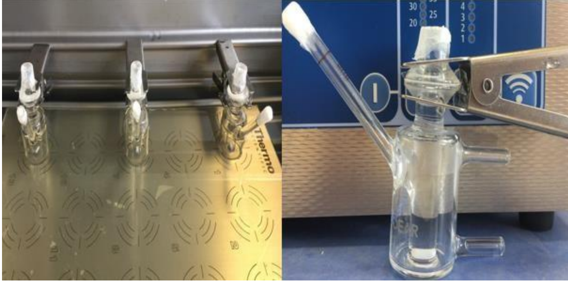
Şekil 3.2. Franz Difüzyon Salım Çalışması
