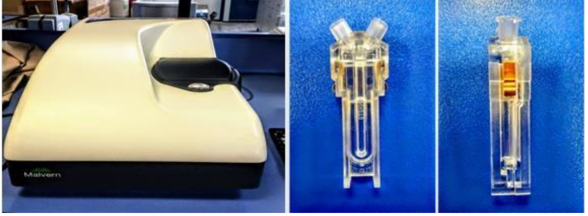
Şekil 3.4. Malvern Zetasizer Cihazı ve Zeta Potansiyeli Ölçümünde Kullanılan Küvetler
