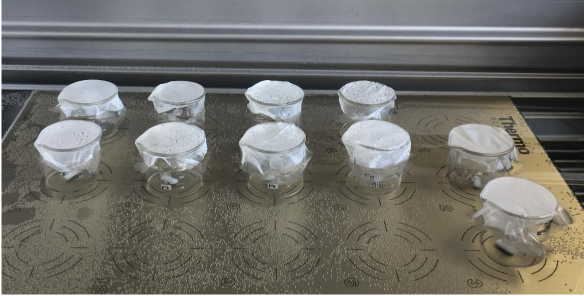
Şekil 3.1. Diyaliz Membrandan İn Vitro Salım Çalışması
