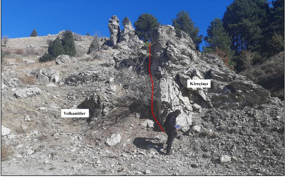
Şekil 5.12. İstasyon-11’de fay etkisi ile karşı karşıya gelen volkanit ve kireçtaşı birimleri
