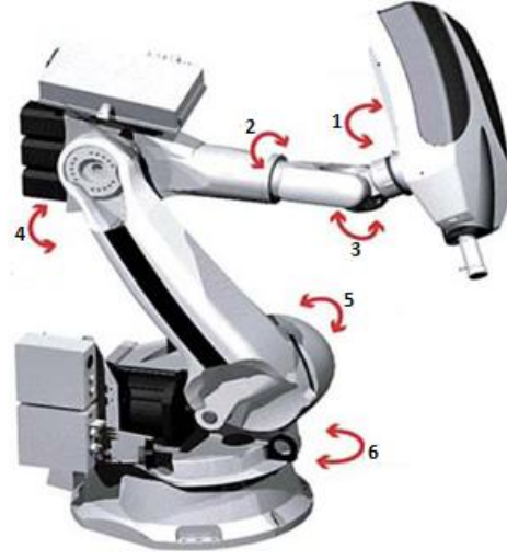
Şekil 2. 4. Altı eksenle hareket edebilen robotik kol
