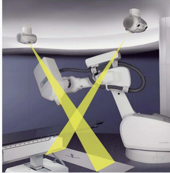
Şekil 2. 6. CyberKnife® Robotik Radyocerrahi cihazına ait ortogonal x-ışını görüntüleme sistemi
