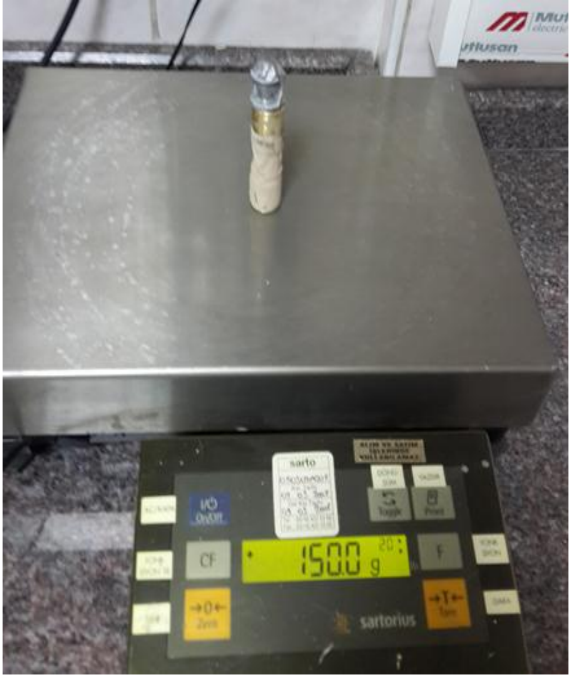
Şekil 3. 4. Travmatik Ödem Oluşturma Modelinde Kullanılan 150 g.'lık Silindirik Cisim
