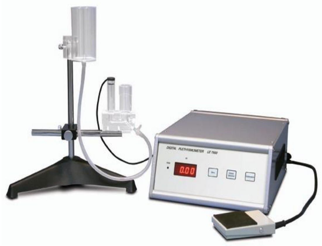
Şekil 2. 16. Pletismometrenin Hacim Ölçümü yapılan Bölümü
