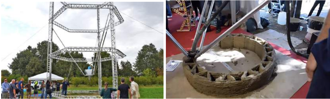
Resim 3.34. Wasp ekibinin yapmış olduğu büyük 3d seramik yazıcı ve çalışma süreci
