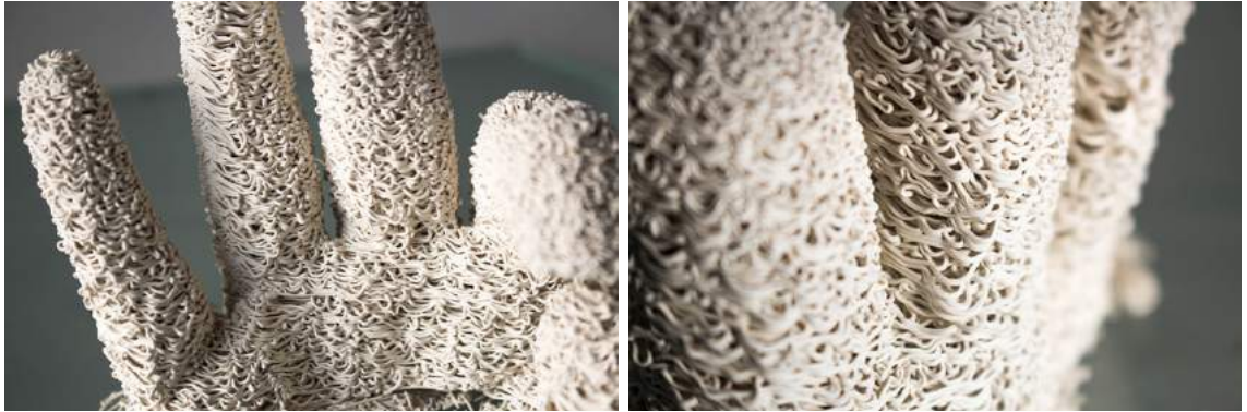
Resim 3.36. Wasp'ın geliştirdiği 0.35mm'lik filamanlar
