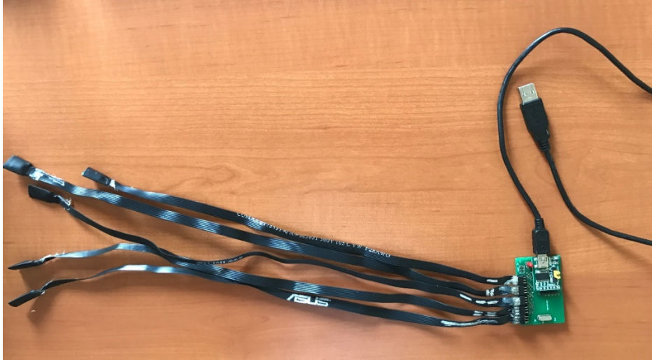
Şekil 3.2. Cihazın 5 sensörü, merkez işlemcisi ve USB bağlantısı
