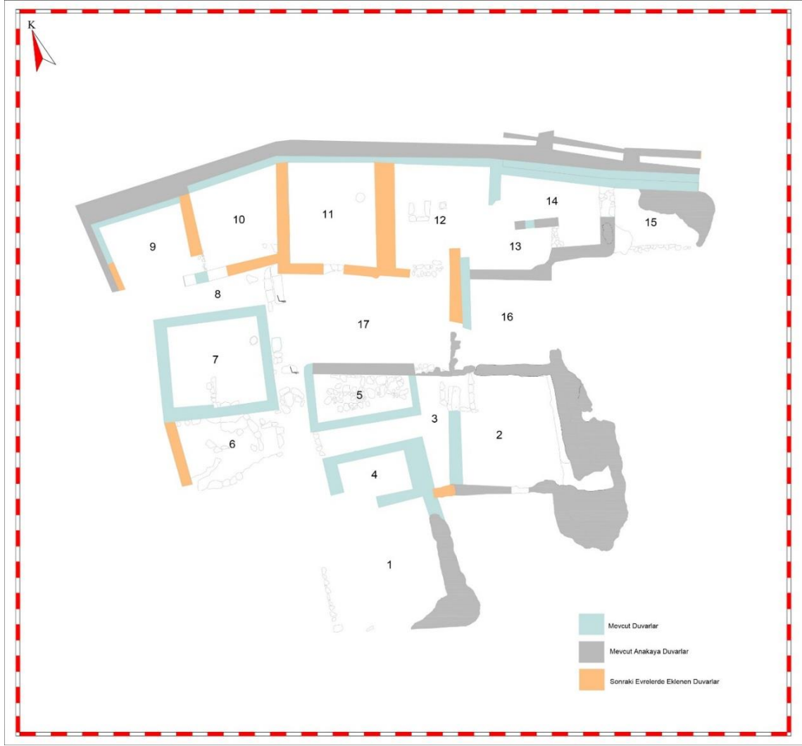
Plan 3: Doğu Villası Dilatasyonlu Duvar Şeması
